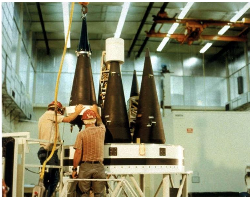
איור 8. ראשי נפץ תרמו-גרעיניים של טיל Peacekeeper. ארה"ב, 1983 תפוקה – עד כ-500 קילו-טונות.
